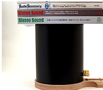
メインバッフル板を平らな所に置き、円筒部分に木工用ボンドを十分に塗って接着して下さい。本などを沢山載せて下さい（10kg以上載せるのがベター）。はみ出た接着剤は濡れた雑巾で拭き取ります。ターミナルの位置にご注意ください（右写真参照）
