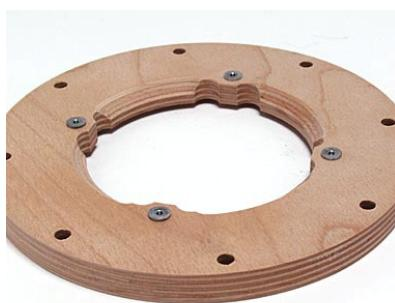
バッフル板のテープ面の付いている方に鬼目ナット M3（各 4 個）を打ち込みます
