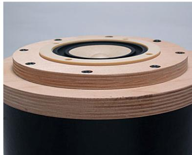
ターミナルの赤側をスピーカープラスに、ターミナルの黒側をスピーカーマイナスをつなぎます。スピーカーを M3 六角ボルトで固定します
