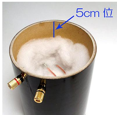
次工程接着のため 5cm 位ずらす。ファストン端子を吸音材にめり込ます
