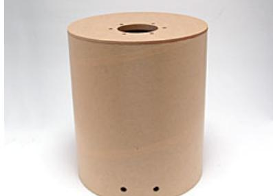
円筒紙管とリアバッフル板を接着します。ターミナル用穴とリアバッフルのバスレフポートのある方を同じ方向にしてください。
