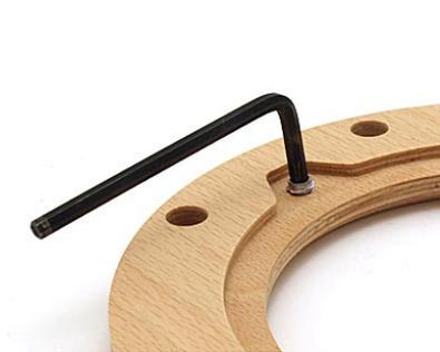
バッフル板の表側からねじ込み式鬼目ナット M4（各 4 個）を付属の六角レンチを使ってねじ込みます。
