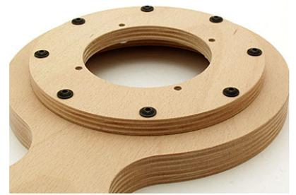
**（重要です！）**鬼目ナットが正確に打ち込まれているか、バッフル板を M5 ボルトで取付けてチェックします。ボルトが入りにくい場合は鬼目ナットがちゃんと入っていませんのでかなづちで鬼目ナットを正確に打ち込んで下さい。（左写真参照）
