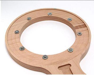
メインバッフル板に M5 鬼目ナット（各 8 個）をかなづちで打ち込みます。間隔の無い様に直角に打ち込みます。
