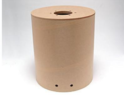
円筒紙管とリアバッフル板を接着します。ターミナル用穴とリアバッフルのバスレフポートのある方を同じ方向にしてください。
