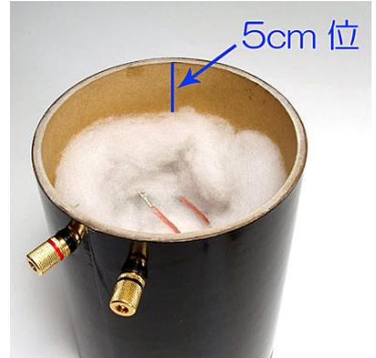
次工程接着のため 5cm 位ずらす。ファストン端子を吸音材にめり込ませます
