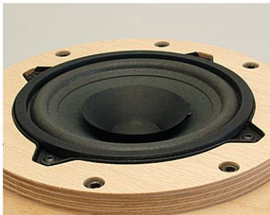
スピーカーユニットをバッフル板に取り付けます。ファストン端子とスピーカー端子をつなぎます。ターミナル赤をプラスに、ターミナル黒をマイナスにつなぎます。M4 ボルトでユニットを固定します。ユニットの上下左右にウレタンスポンジを貼り付けます。
