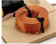
各部品を接着剤で MDF 板に固定します。ゴム系接着剤や木工用接着剤を使用します。
